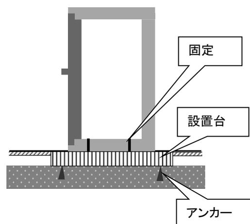
注1) アンカー固定ピッチを100mm以下にすると引き抜き耐力が低下しますので注意してください。
