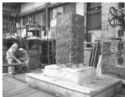
金庫の耐火試験状況
