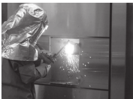
金庫設備の防盜試験状況
